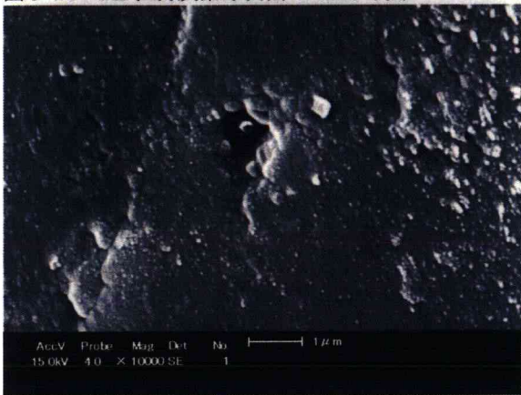
図 3-4-2 Mo 担持炭素球表面の拡大 SEM 写真
