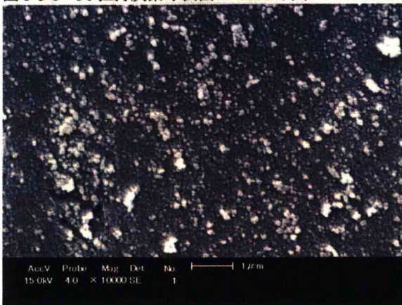
図 3-5-2 Fe 担持炭素球表面の拡大 SEM 写真
