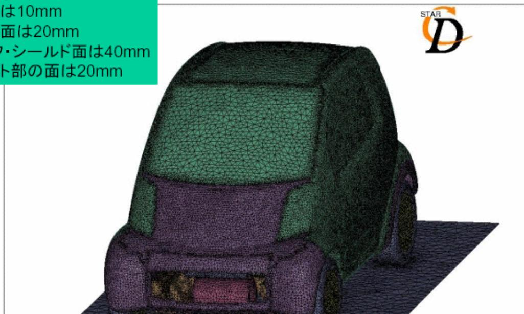
Fig.34 電動車両の熱流体解析メッシュ
