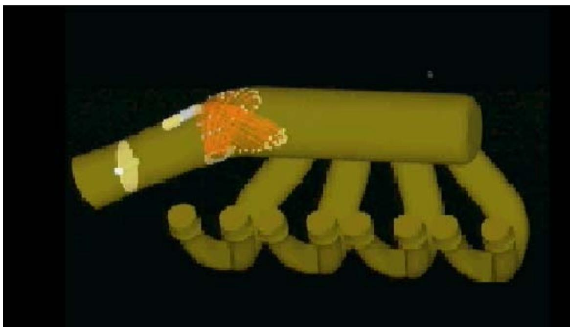
Fig.32 新しい EGR マニホールドにおける排気ガスの流入状況（流跡線）
