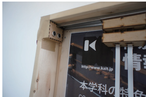
(d) X 軸取得のための超音波センサ
