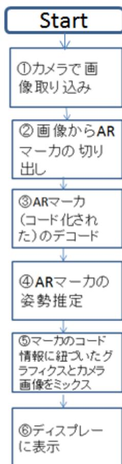
図 4.3-3 3次元 AR マーカ認識のシステムフロー
