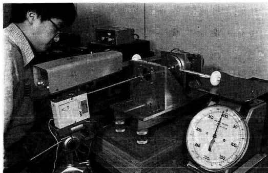
図5. 運転特性及びロータ振動加速度の測定
